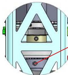
Beide Rotorköpfe so ausrichten das jeweils ein Blatthalter genau nach vorne in Flugrichtung zeigt. Ist das nicht der Fall die Madenschrauben lösen und die Köpfe so verdrehen bis beide gleich ausgerichtet sind. Danach beide Madenschrauben mit Schraubensicherung sichern. Darauf achten das die Maden so weit eingeschraubt werden bis sie bündig am Flansch anliegen.
