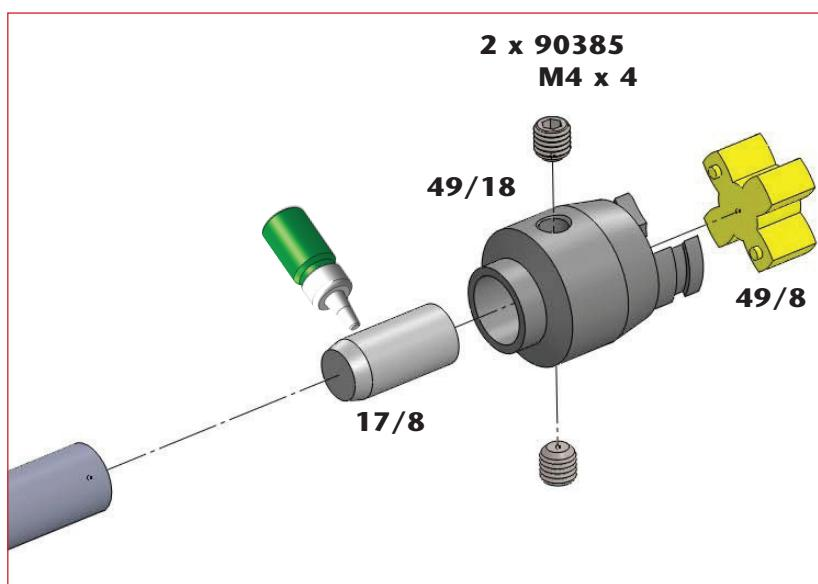
Heckanschluss vorn und hinten verbinden und dann den Abstand zwischen dem Heckrotorhalter und der Heckrotorananschraubfläche messen. Antriebswelle nun um den so ermittelten Wert kürzen und wieder alles einbauen.
