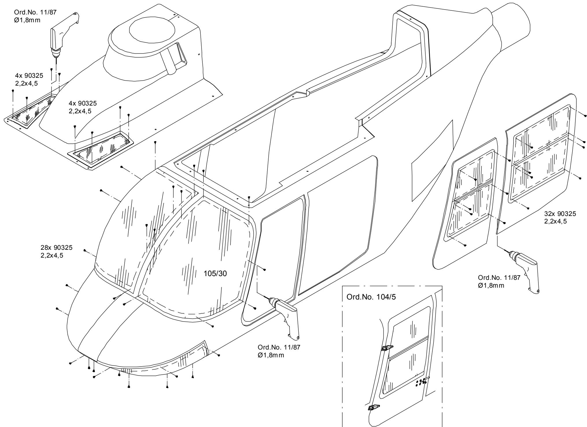
Spantensatz Jet Ranger III
