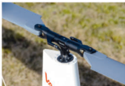
Rotorhodet er veldig bra, og er en «Vario-variant» av Oxy 5-hodet. En av modifikasjonene er en svært lang spindleasting. Dette gjør at Thrustlageret stikker ut på hver side, og følgelig vil kun Varios egne rotorblader med kort rot passe.
