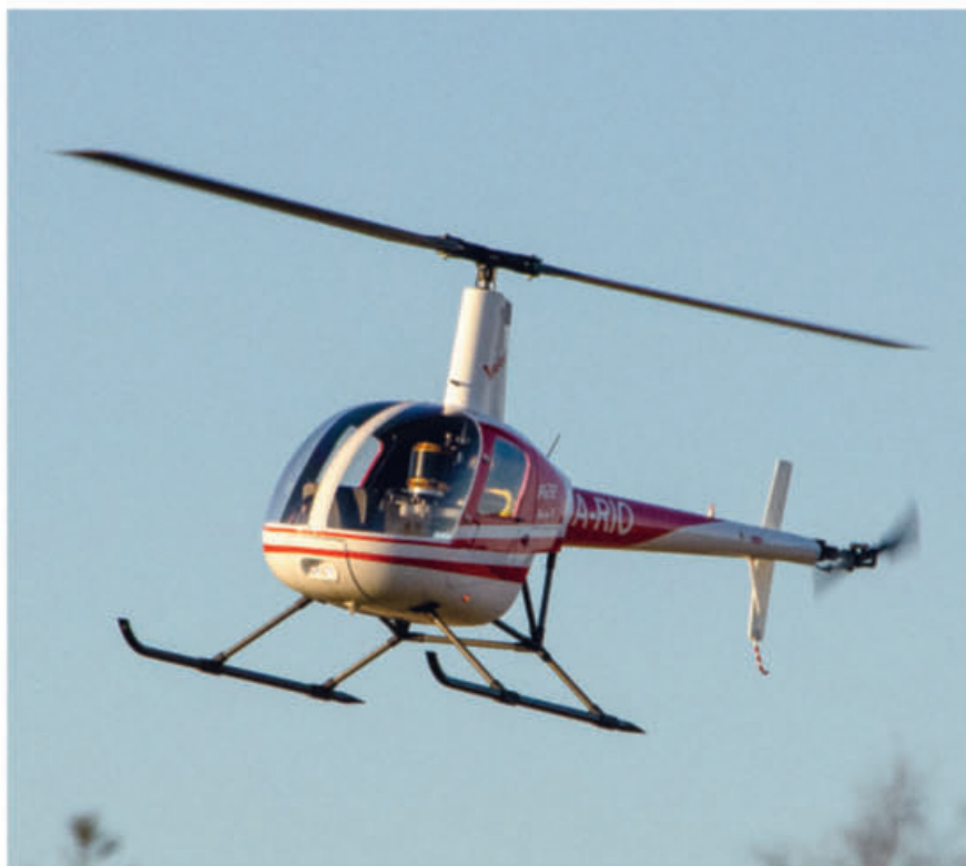
Det brede (men dessverre litt skjøre) understellet og den høye masta gjør at modellen er veldig stabil, vel og merke når man får roet ned utslagene på cyclic tilstrekkelig.
