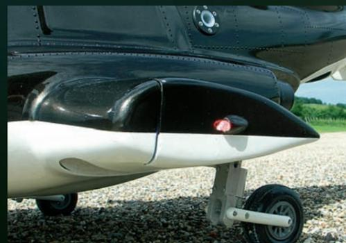
Erst fahren die seitlichen Abdeckungen inklusive der MGs aus, dann werden die Läufe teleskopiert. Hier erkennt man auch gut die »Zielerfassungs-LEDs« in den Abdeckungen.
