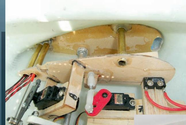
Die ausfahrbaren Geschütze werden mit je zwei Servos angesteuert. Eins fährt die Einheit aus, ein zweites teleskopiert den Lauf. Ein Mikroschalter sorgt dafür, dass das Abfeuern nur im ausgefahrenen Zustand möglich ist.
