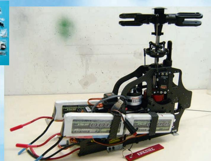
Vor dem Aufbau des Rumpfs wurde die Silence-Mechanik montiert und stand so zur Anpassung des Airwolfs zur Verfügung.
