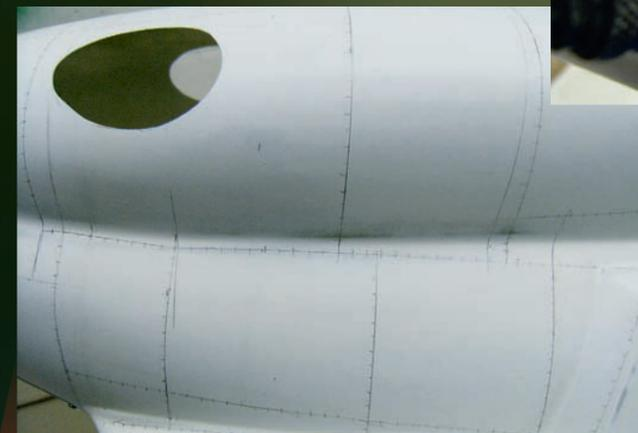
Geduldsspiel: Die insgesamt 3.887 Nieten wurden vom Autor zunächst angezeichnet, dann einzeln gebohrt und eingesetzt. Das Ergebnis entschädigt für den Aufwand.
