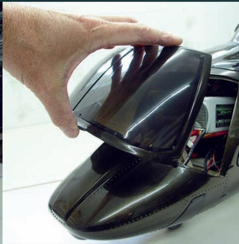
Der Akkuwechsel kann einfach von vorn durch die abnehmbare Cockpitverglasung erfolgen.
