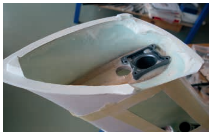
La cloison une fois ajustée avec l'adaptateur, de côté la trappe de service
