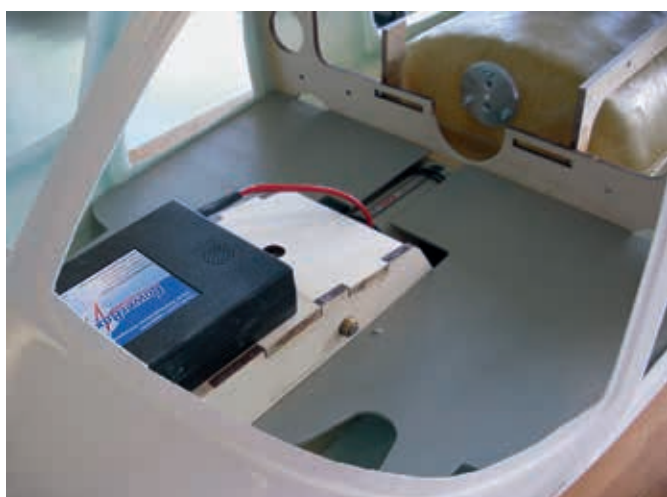
Le plancher du poste de pilotage est ajusté puis vissé provisoirement
