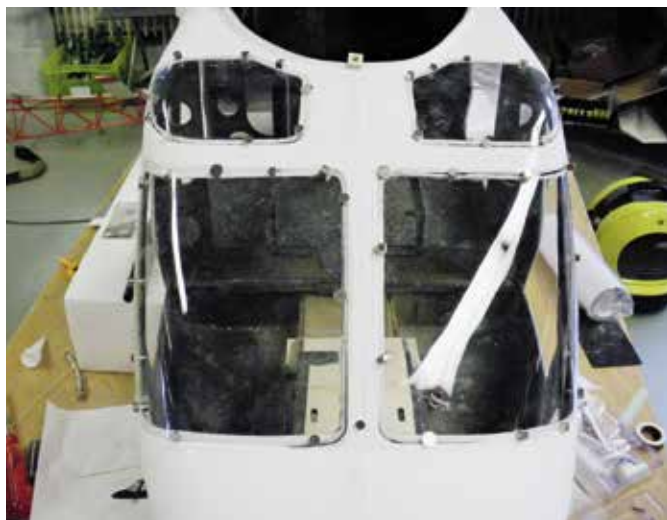
So klebe ich die Scheiben mit Silikon-Kautschuk ein, die Magnete sind Gold wert!
