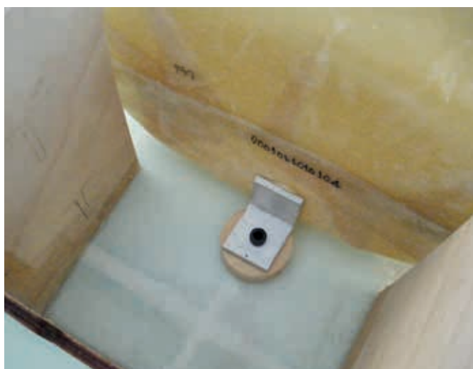
Le réservoir principal en GFK est fixé au sol par deux vis M4
