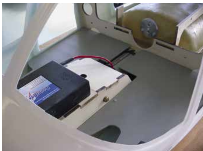
Der Cockpitboden wird eingepasst und provisorisch verschraubt
