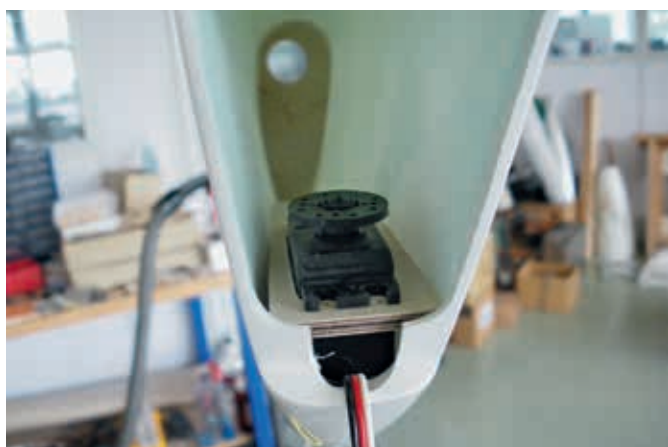
Le servo arrière est situé dans la poutre de queue, on aperçoit l'ouverture pour le rotor anticouple
