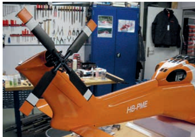
L'assemblage final commence, rotor anticouple et carénage ont pris place!
