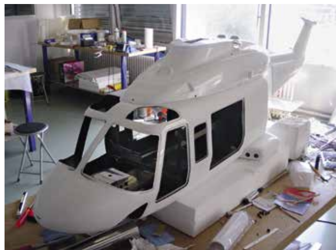
Die Domabdeckungen werden angepasst und mit M 2.5 Schrauben festgeschraubt
