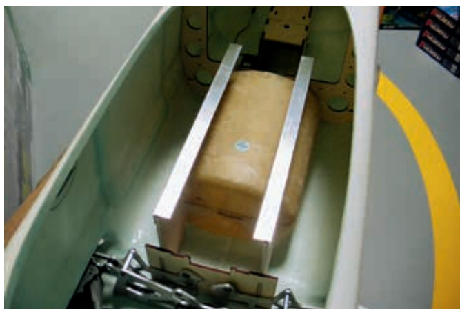
Les profilés en aluminium serviront plus tard de supports pour la plaque de base de la mécanique à turbine
