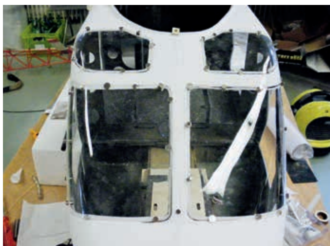
Je colle les vitres avec un caoutchouc siliconé, les aimants valent de l'or !
