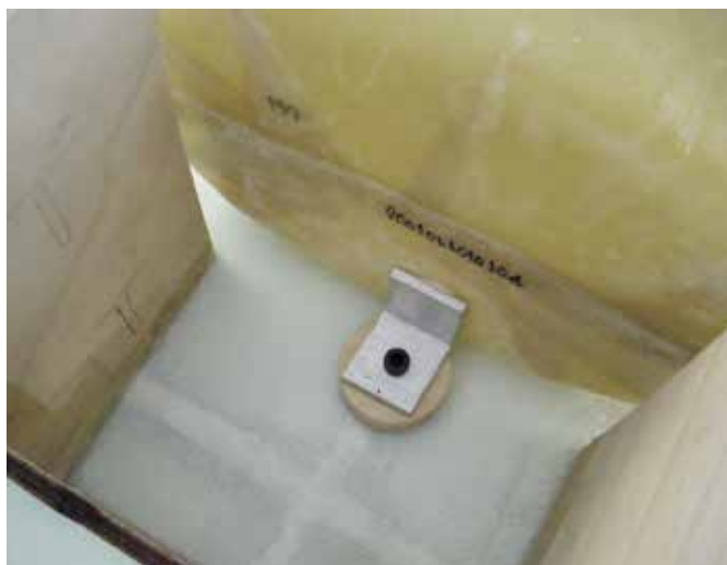
Der GFK-Haupttank wird mittels zweier M4-Schrauben am Boden festgehalten
