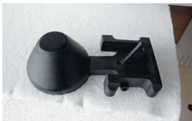
Le projecteur escamotable peint en noir mat, prêt à être installé
