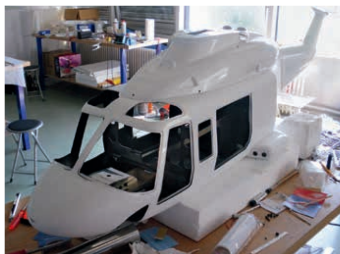
Les carénages de dôme sont ajustés puis fixés au moyen de vis M2.5
