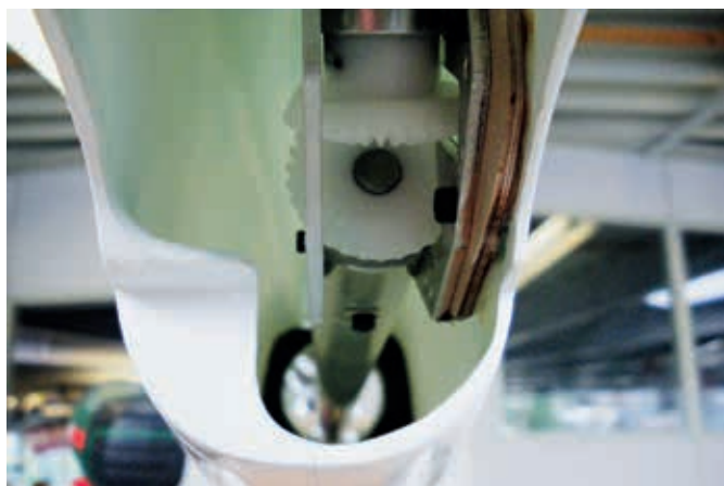
L'engrenage angulaire est fixé de côté sur une cloison en contre-plaqué
