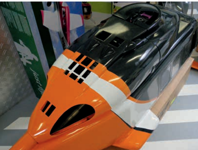
Le revêtement multicouche avec sa surface Clear Coat légèrement «façonnée»
