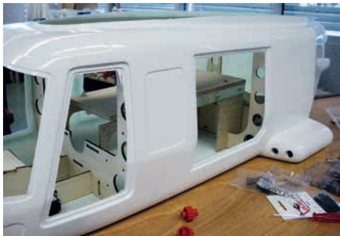
Tout est mis en place après ébavurage de l'intérieur
