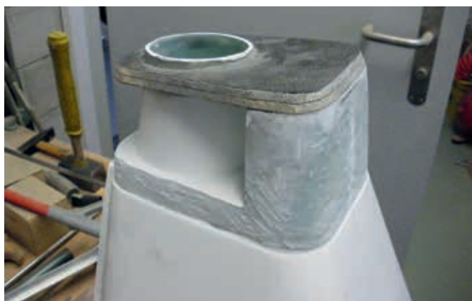
Cloison supplémentaire en carbone / balsa pour un collage stable de la queue !
