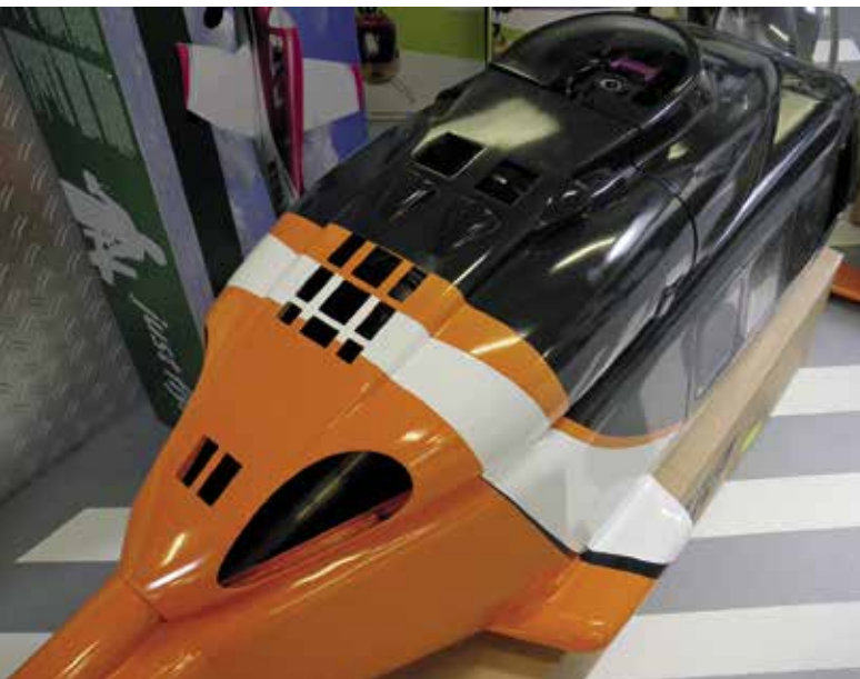
Die Mehrschichtlackierung mit dem leicht „abgestochenen“ Klarlack
