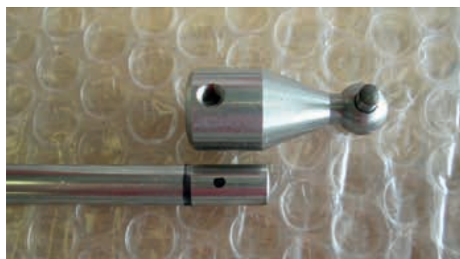
Les cardans d'accouplement sont collés et vissés sur l'arbre
