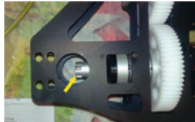
Le système d'accouplement de l'arbre d'anti-couple sur la mécanique.
