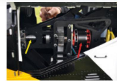
Le bloc moteur et la prise de force de l'anticouple.
