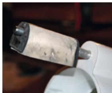
Un des blocs qui assurent la liaison cabine / poutre arrière.
