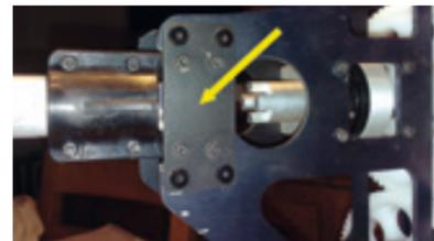
La fixation du tube de queue est assurée par deux plaquettes en métal vissées sur le châssis.
