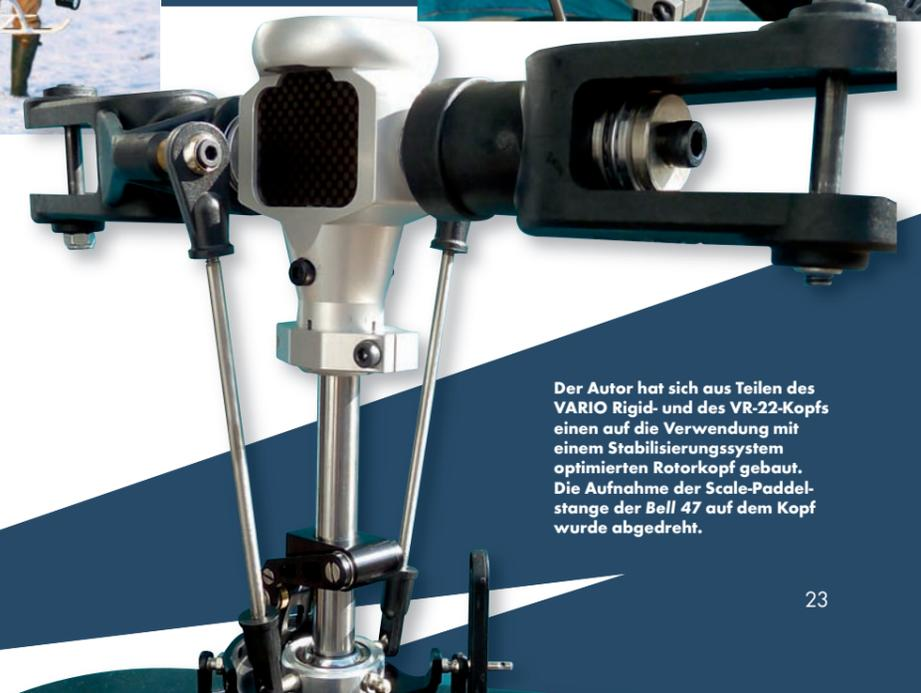
Der Autor hat sich aus Teilen des VARIO Rigid- und des VR-22-Kopfs einen auf die Verwendung mit einem Stabilisierungssystem optimierten Rotorkopf gebaut. Die Aufnahme der Scale-Paddelstange der Bell 47 auf dem Kopf wurde abgedreht.
