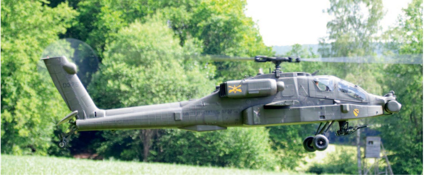
Ein beachtliches Modell: Der AH-64 Apache im Maßstab 1:7 (Rotordurchmesser 2.100 mm) von Gabriele Pierini aus Italien. Abflugfertig wiegt das Modell 18,5 kg. Das Antriebsset besteht aus einem Kontronik Pyro 800 und einem Kosmik 200. Das Modell ist sehr vorbildgetreu aufgebaut und wurde u.a. mit einem Scale-Cockpit und einer detailreichen Maschinenkannone ausgestattet.
