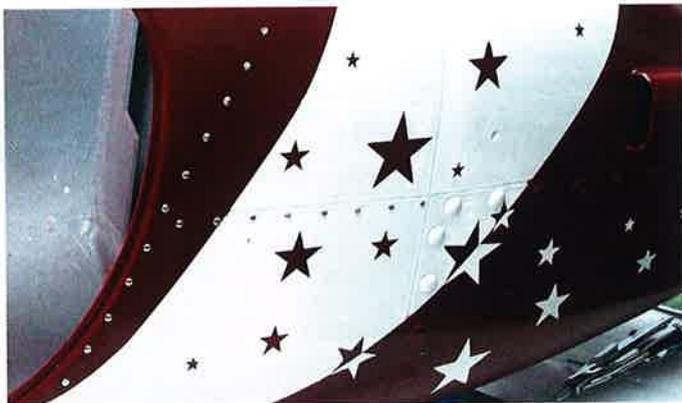
Das fertige Finish mit Nailheads als Niete-Imitation. Deutlich sichtbar auch der simulierte Stoßkanteneffekt.
