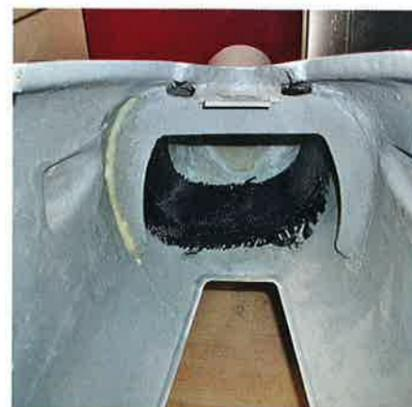
Die Reparatur an der Innenseite des Rumpfs erfolgte mit zwei Lagen 200 g-Kohlematten und 24h-Epoxydharz.
