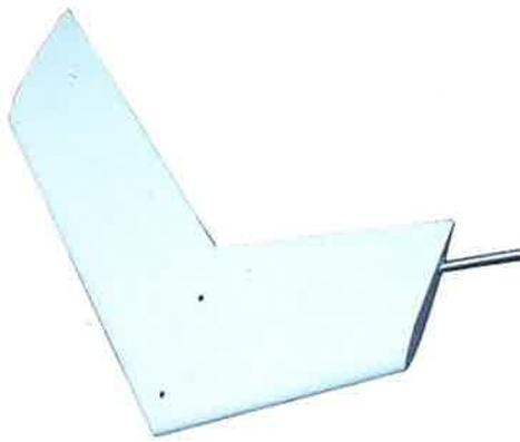
Das Seitenleitwerk (oben) mit dem aus 6 mm-Alurohr gefertigten Hecksporn.
