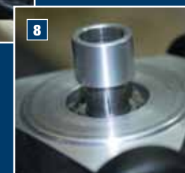
Das Zentralstück hat drei Vertiefungen für die Aufnahmestifte
