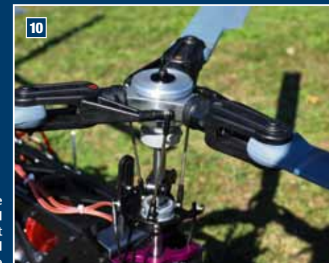
Der fertig mit Anlenkungen versehene Dreiblatt. Er besitzt eine definierte und super weiche Dämpfung. Wird ein Blatt angehoben, ändern sich die Anstellwinkel der beiden anderen Blattarme
