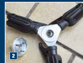
Das Zentralstück hat ein eingebautes Schwenklager, sodass der Rotorkopf – ähnlich einer Taumelscheibe – frei auf der Hauptrotorwelle pendeln kann
