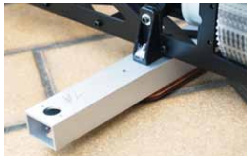
An der Mechanik verschraubte Kunststoff-Fahrwerksträger mit Bodenprofil
