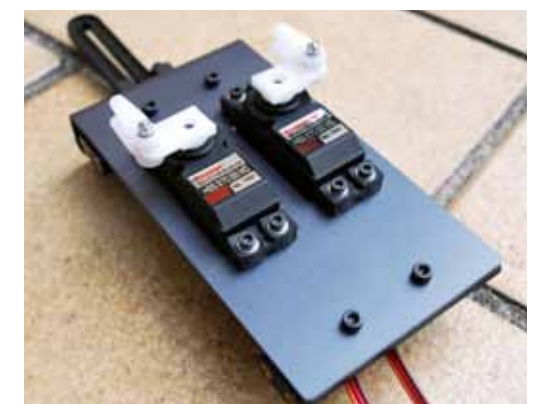
Am vorderen und hinteren Mechanikteil werden jeweils diese beiden Servo-Aluspanten eingebaut. An den Servohebeln sind bereits kugelgelagerten Anlenkköpfe verschraubt (Abstand 12,5 Millimeter)
