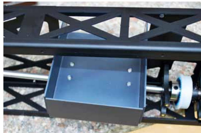
Der Akku-Aufnahmekasten besteht aus eloxiertem Alu
