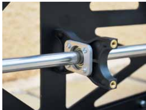
Die Edelstahlwelle ist fünf Mal in der Mechanik gelagert
