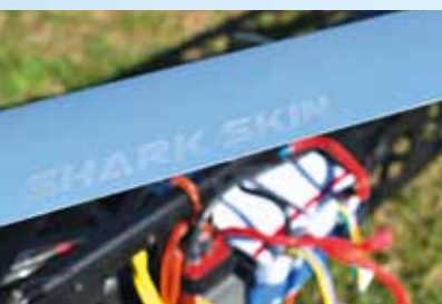
Die Shark Skin-Rotorblätter von Vario sind halbsymmetrische GFK-Blätter mit einer Länge von 680 Millimeter. Die Schrift befindet sich immer auf der Oberseite
