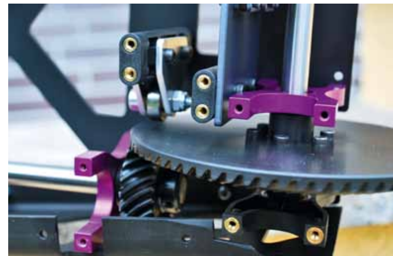
Die palliodverzahnten Zahnradpaarung für die beiden Hauptrotorantriebe stammen aus dem Turbinenbereich. Deutlich zu erkennen ist auch das kleine Stützkugellager auf dem großen Tellerrad
