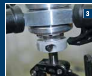
Die Rotorkopf-Aufnahme wird mit einer M3-Schraube und einem Klemmring auf der Hauptrotorwelle befestigt
