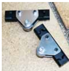
Die beiden im Text beschriebenen Andrucklager für das große Tellerrad
