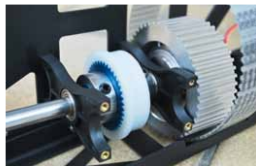
... so aussieht. Die beiden M5-Schrauben an der Kupplungsverbindung werden gelöst und der vordere und hintere Rotor so lange verdreht, bis sie parallel stehen. Das gewährleistet ein Ineinanderkämen der Rotoren
