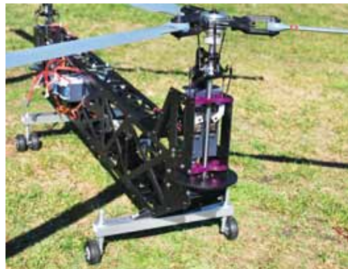
Die fertig aufgerüstete, selbsttragende Tandem-Mechanik in der „nackten“ Trainer-Variante noch ohne Rumpf während der ausgiebigen Flugerprobung
