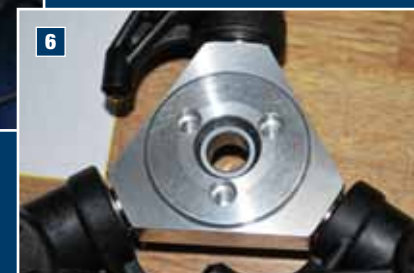
Das Zentralstück hat drei Vertiefungen für die Aufnahmestifte
