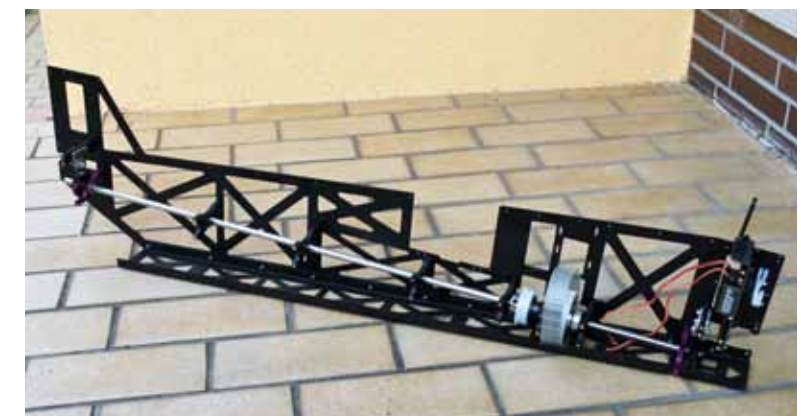
So wird das Verbindungsrohr aus 10-mm-Edelstahl mit seinen Lagerböcken im Seitenteil eingebaut
