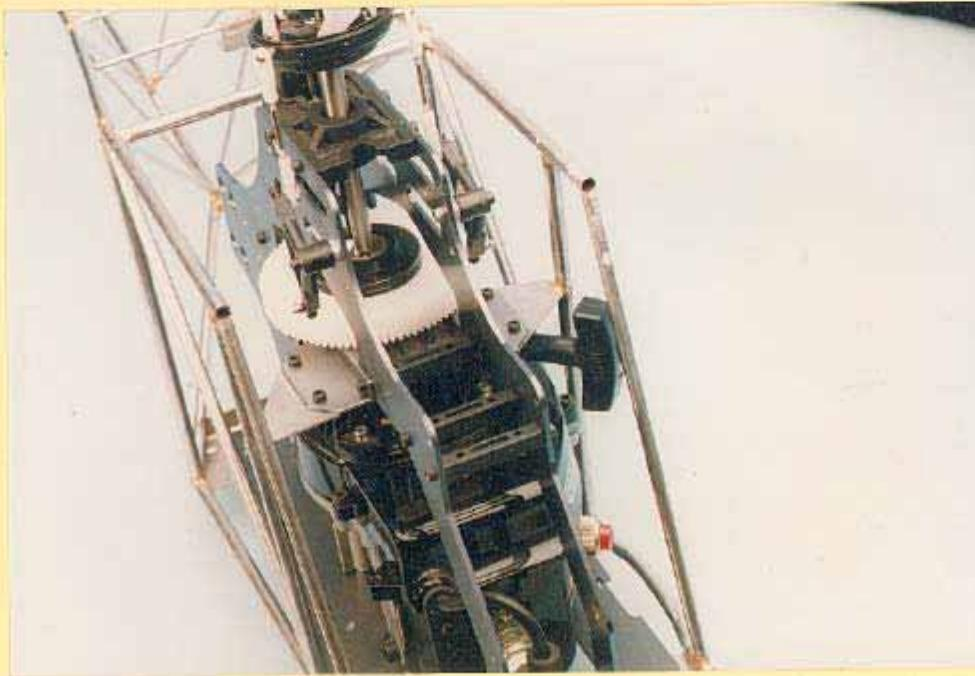
Obere Befestigung, Inbusschraube M 3 x 8 und Stoppmutter.
