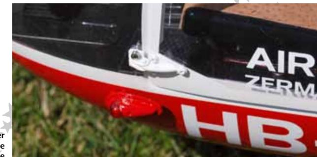
Blick auf eines der Türscharnieren und eine Positionsleuchte
