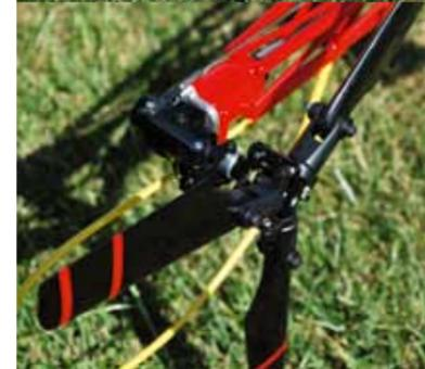
Der Benda Heckrotor mit Dreiblatt-Nabe von Vario und deren Anlenkung
