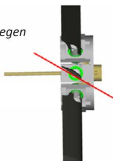
Maximaler Steuerausschlag mit dem Drehmoment: ca. 10°
